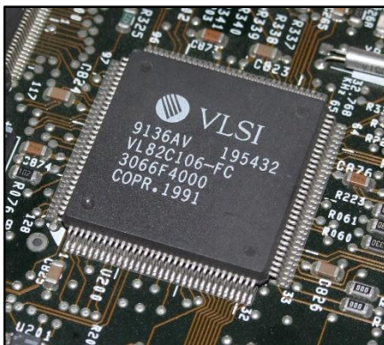
ภาพที่ 1.16 ตัวอย่างลักษณะวงจรรวมขนาดใหญ่ (VLSI)
