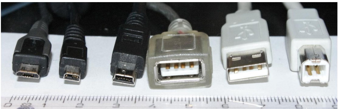
ภาพที่ 2.34 ปลั๊ก Micro-B, ปลั๊ก UC-E6, ปลั๊ก Mini-B, ตัวรับ A , ปลั๊ก type-A, ปลั๊ก type-B
