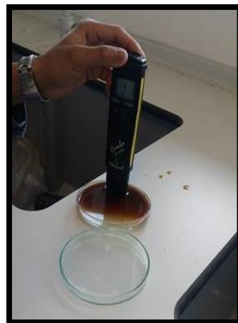
ภาคผนวกที่ 14 แสดงการวัดค่า pH ของน้ำ หมักใบสาบเสือ
