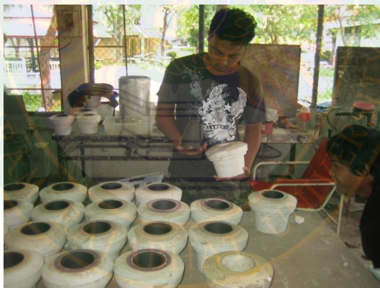
ภาพที่ 24 ชิ้นงานเริ่มหลุดร่อนจากแม่พิมพ์ การแกะชิ้นงานออกจากแม่พิมพ์
