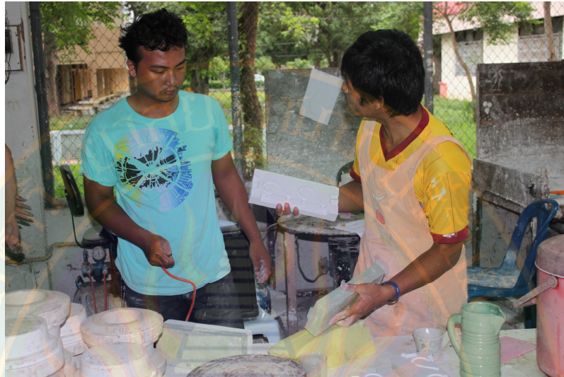
ภาพที่ 17 การเตรียมแม่พิมพ์สำหรับประกอบส่วนหู
