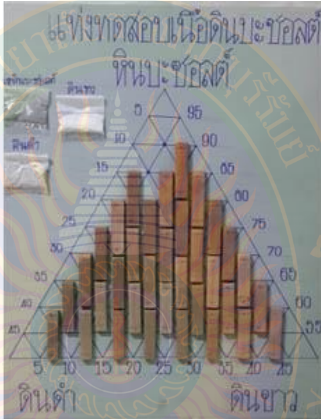
ภาพที่ 38 การหาค่าความแกร่งหลังเผาที่อุณหภูมิ 1,100 องศาเซลเซียส
