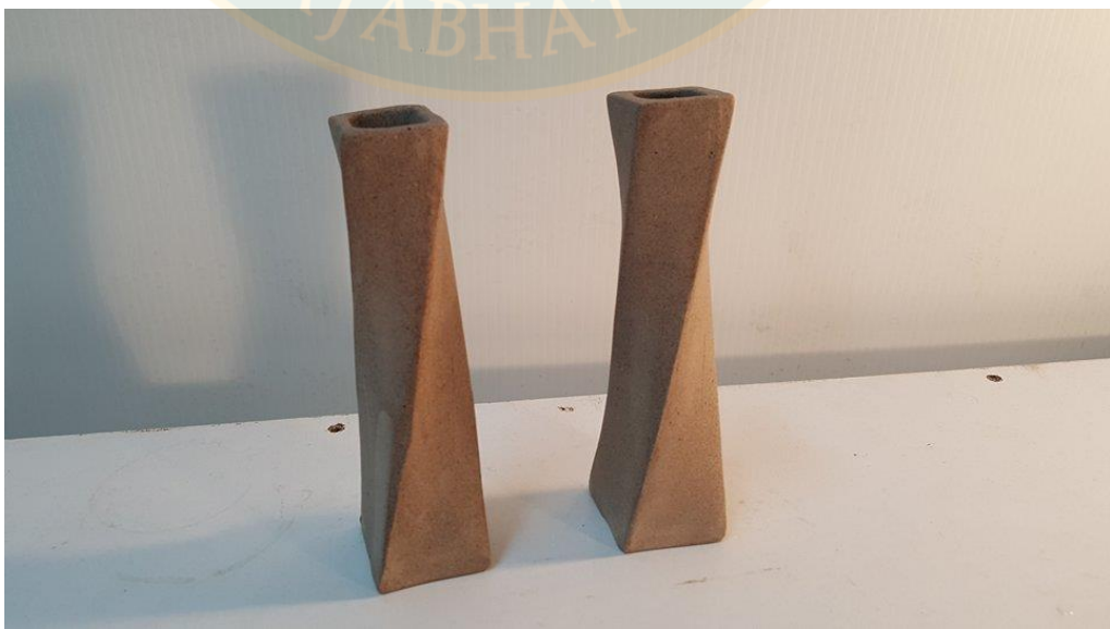
ภาพที่ 74 ชิ้นงานเนื้อดินหล่อผสมผงหินบะซอลต์ หลังเผา 1,100 องศาเซลเซียส
