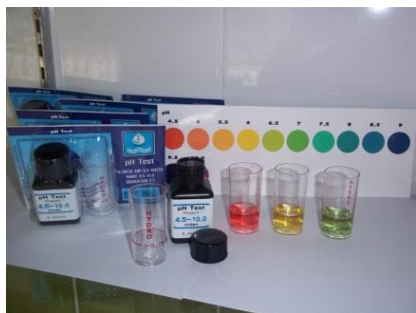
ภาพที่ 11 ชุดตรวจสอบหาค่า pH
