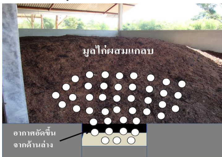
ภาพที่ 4 กระบวนการหมักแบบเติมอากาศ เปิด - ปิดด้วยนาฬิกาอัตโนมัติ วันละ 6 ครั้ง โดยเปิดครั้งละ 1 ชั่วโมง รวมทั้งสิ้นวันละ 6 ชั่วโมง และปิดครั้งละ 3 ชั่วโมง รวมทั้งสิ้นวันละ 18 ชั่วโมง
