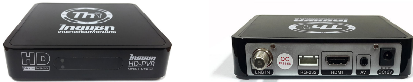
ภาพที่ 4.20 รีซีฟเวอร์แบบธรรมดา ไม่มี RF OUT
