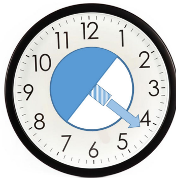
ภาพที่ 4.30 การวางตำแหน่งขั้วของ LNB ระบบ KU-Band
