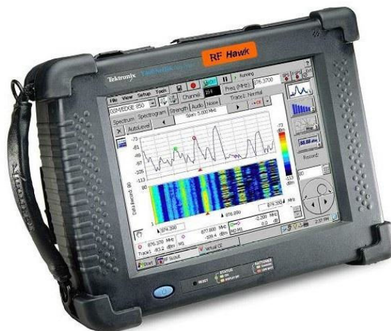
ภาพที่ 5.23 Spectrum Analyzer ที่มา : H600/SA2600 Series Spectrum Analyzer (2011 : 1)
