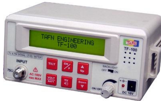
ภาพที่ 5.22 เครื่องวัดความแรงสัญญาณ RF ยี่ห้อ TAFN TF-100 ที่มา : TV & FM Signal Level Meter (2005 : 2)
