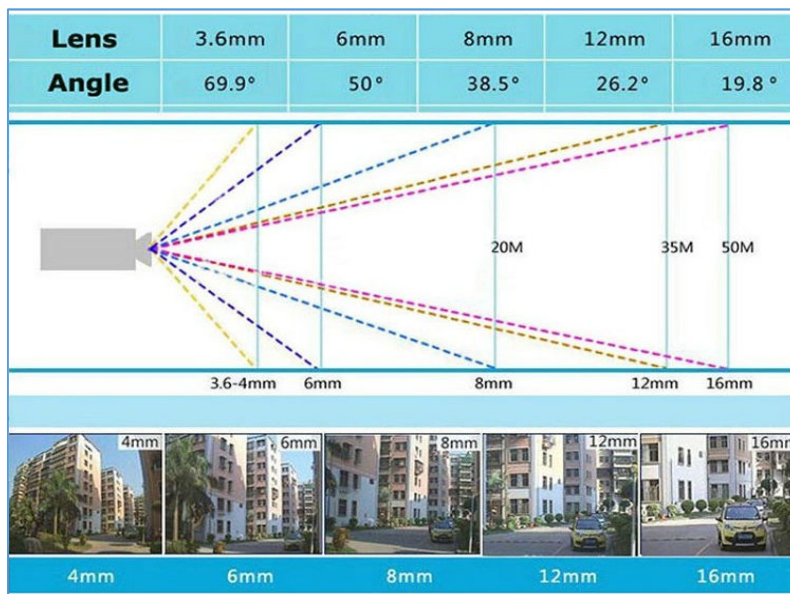
ภาพที่ 8.7 มุมกล้องและขนาดของเลนส์ ที่มา : ทำความเข้าใจกับเลนส์กล้องวงจรปิด (2561 : 1)
