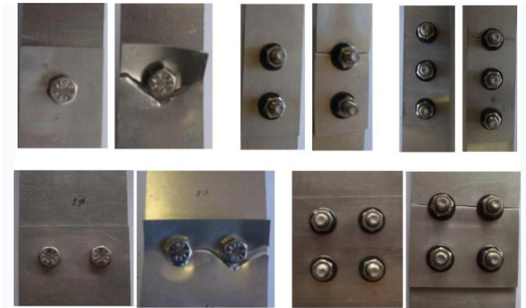
ภาพที่ 2.21 การวิบัติของรอยต่อแผ่นวัสดุโดยใช้สลักเกลียว
