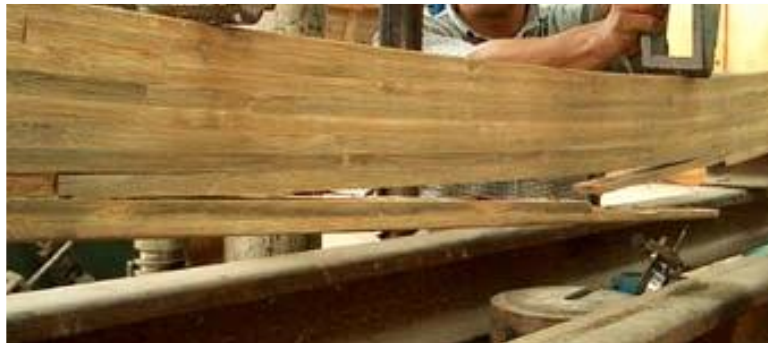
ภาพที่ 5.2 การวิบัติของคานไม้เนื่องจากโมเมนต์คด ที่มา : Construction with Bamboo. 2005
