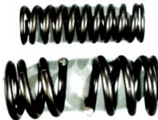
ภาพที่ 3.27 การวิบัติของขดสปริงเนื่องจากการบิด
