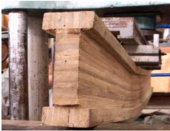
ภาพที่ 5.19 การวิบัติของคานไม้ประกอบรูปตัวไอเนื่องจากความเค้นเฉือนแนวราบ
