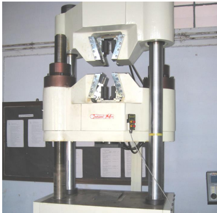
ภาพที่ 1.17 เครื่องทดสอบอเนกประสงค์
