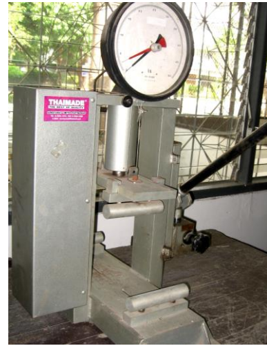
(ข) เครื่องทดสอบโมเมนต์ดัด
