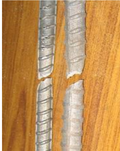
(ข) การวิบัติของเหล็กข้ออ้อยภายใต้แรงดึง
