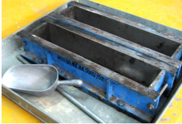
(ก) แบบหล่อคอนกรีตคานคอนกรีต
