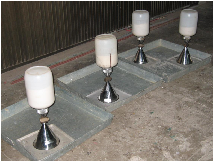
ภาพที่ 2.47 การหาปริมาณทรายในกรวย ที่มา : จิรวัดน์ วิมุตติสุขวิริยา. 2558
