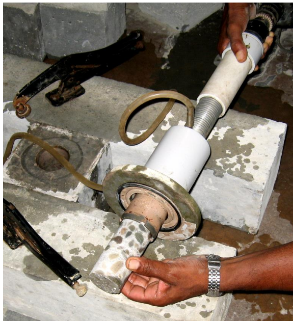
ภาพที่ 3.28 การเจาะเก็บตัวอย่างคอนกรีตที่แข็งตัวแล้ว
