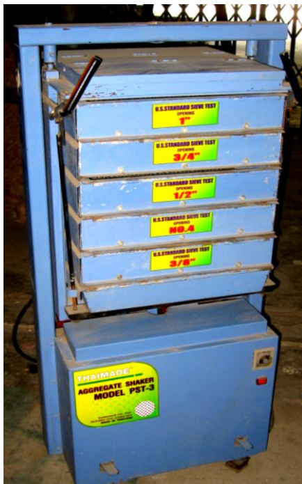
(ก) เครื่องเขย่าตะแกรงร่อนหิน
