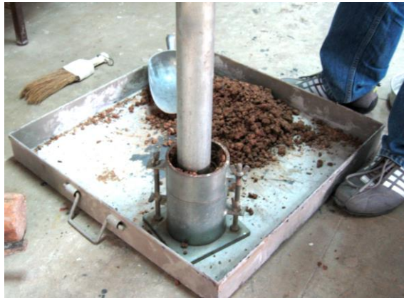
(ก) การใช้ค้อนบดอัดดินในแบบหล่อตามจำนวนครั้งที่กำหนด
