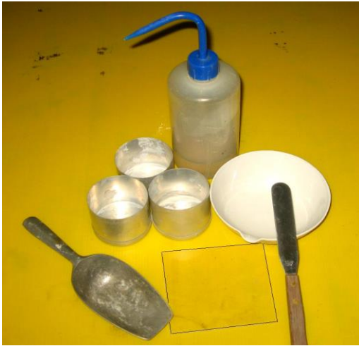
(ก) ชุดทดสอบขีดจำกัดพลาสติกของดิน
