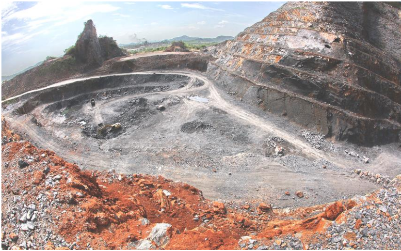
ภาพที่ 1.5 ลักษณะเหมืองหินแบบชั้นบันไดในพื้นที่ภูเขา
