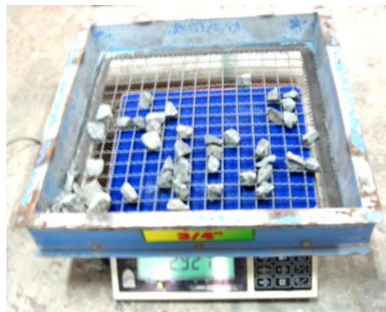
(ข) การชั่งน้ำหนักหินที่ค้ำบนตะแกรง
