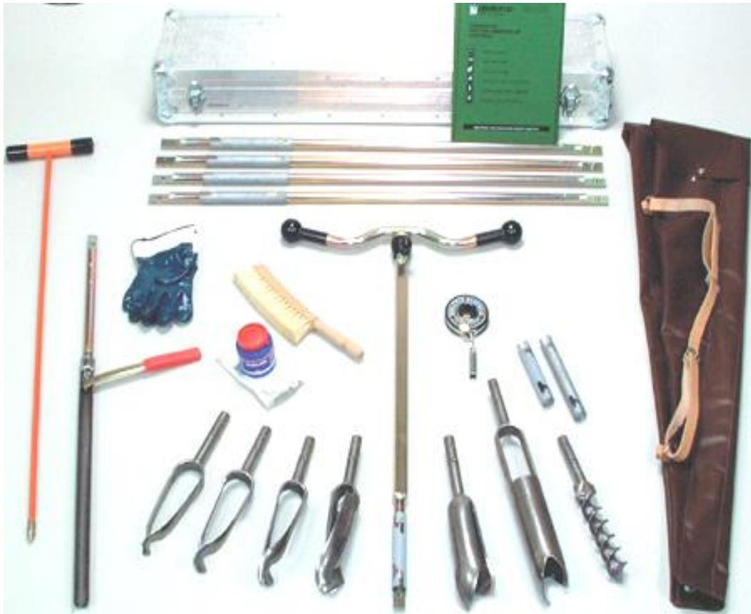
ภาพที่ 2.19 เครื่องมือการเจาะสำรวจดินด้วยสว่านมือ
