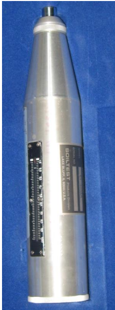
(ก) ค้อนกระแทกแบบสมิทธ์ (ข) การแปลงผลที่อ่านได้จากค้อนเป็นกำลังอัดคอนกรีต
