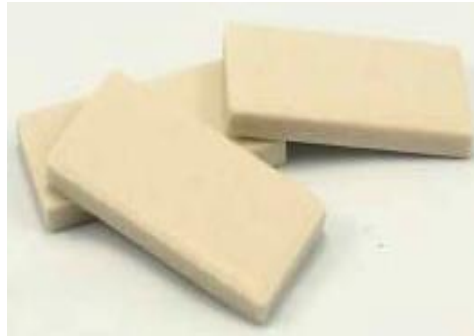
(ข) แผ่นกระเบื้องที่ยังไม่ได้เคลือบ
