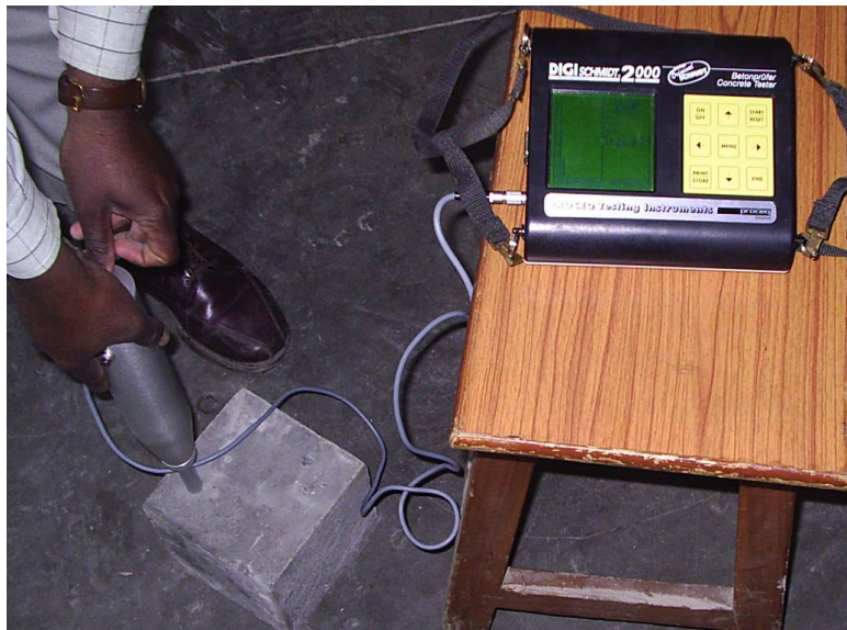
ภาพที่ 3.33 การทดสอบกำลังอัดคอนกรีตแบบใช้ค้อนกระแทกและประมวลผลอัตโนมัติ ที่มา : จิรวัดณ์ วิมุตติสุขวิริยา. 2558
