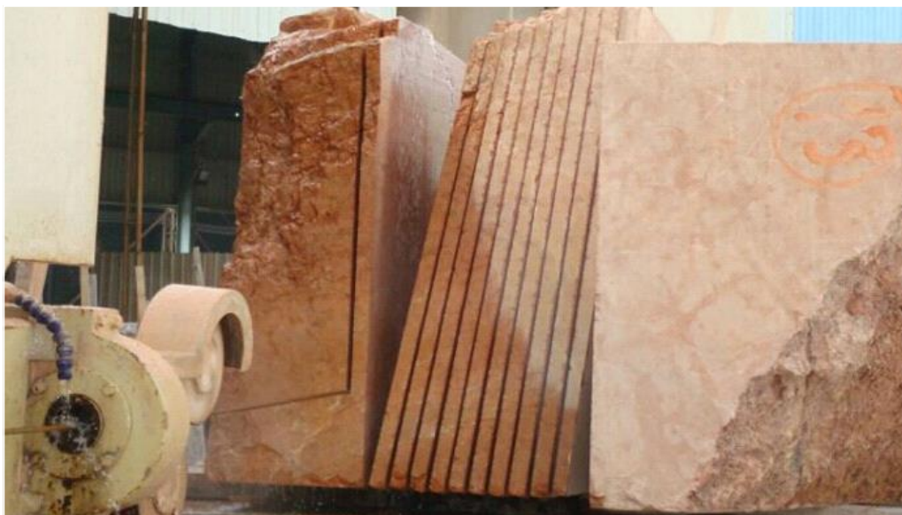
ภาพที่ 1.12 การตัดหินด้วยเครื่องตัดหินแบบลวดเพชร
