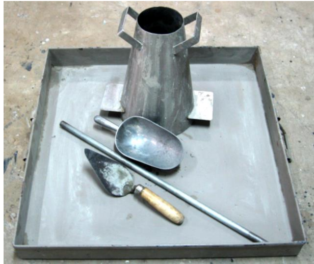
ภาพที่ 3.21 อุปกรณ์ที่ใช้ทดสอบค่ายุบตัวของคอนกรีตสด
