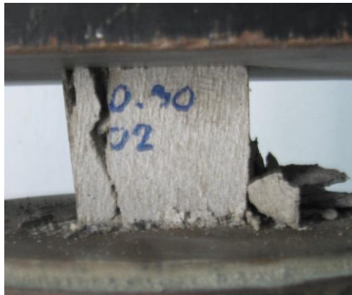
(ข) การวิบัติของซีเมนต์มอร์ตาร์ภายใต้แรงอัด
