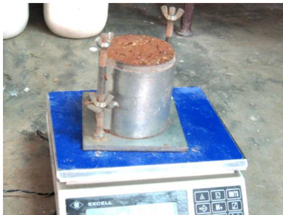
(ค) การชั่งน้ำหนักดินในแบบหล่อเพื่อนำไปหาความหนาแน่น
