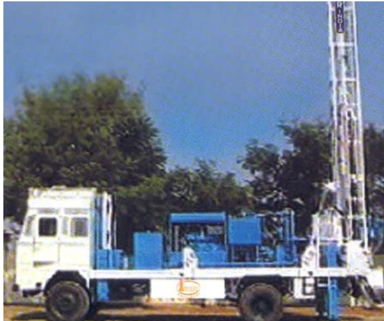
ภาพที่ 2.21 เครื่องจักรกลที่ใช้ในการเจาะสำรวจดินแบบเจาะปั่น
