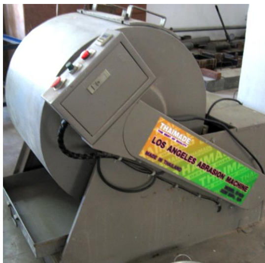
(ก) เครื่องทดสอบลอสแอนเจลิส
