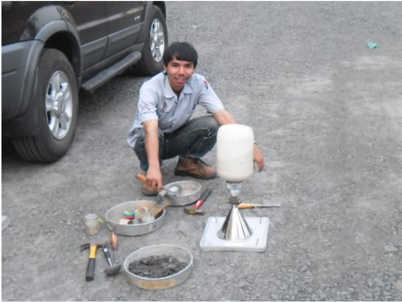
ภาพที่ 2.46 การหาปริมาณหลุมเจาะโดยการใช้ทรายแทนที่ ที่มา : จิรวัดน์ วิมุตติสุขวิริยา. 2558
