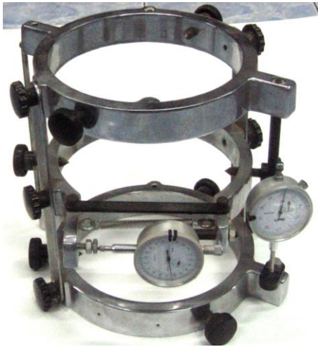
(ก) ชุดอุปกรณ์เสริมสำหรับวัดการเสียรูป
