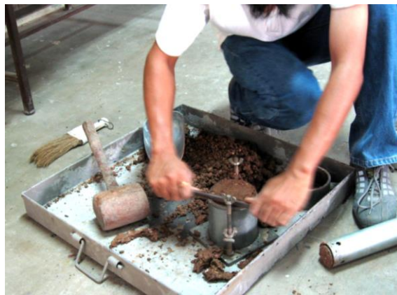
(ข) การปาดดินให้เรียบเสมอแบบหล่อ
