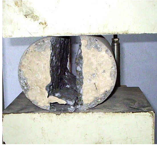
ภาพที่ 3.30 การทดสอบกำลังดึงของคอนกรีตทรงกระบอกแบบผ่าซีก
