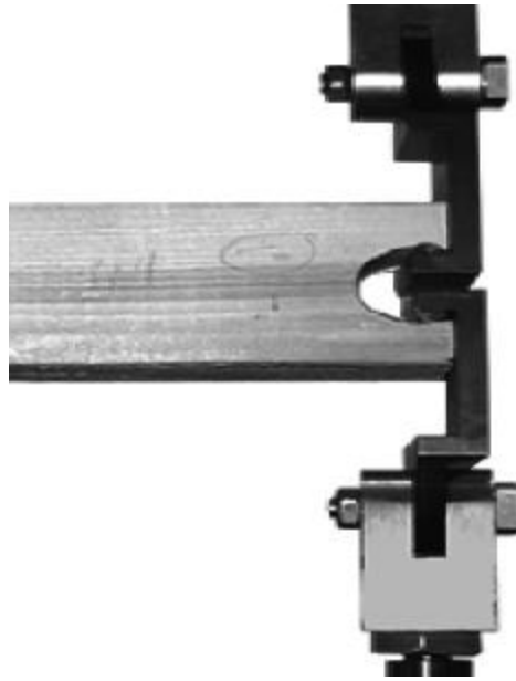
(ข) เครื่องทดสอบกำลังแตกริ้ว
