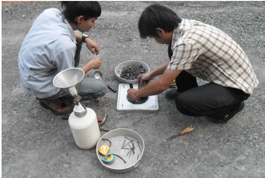
ภาพที่ 2.45 การเก็บตัวอย่างดินหรือหินคลุกบดอัดแน่นในภาชนะ ที่มา : จิรวัดณ์ วิมุตติสุขวิริยา. 2558
