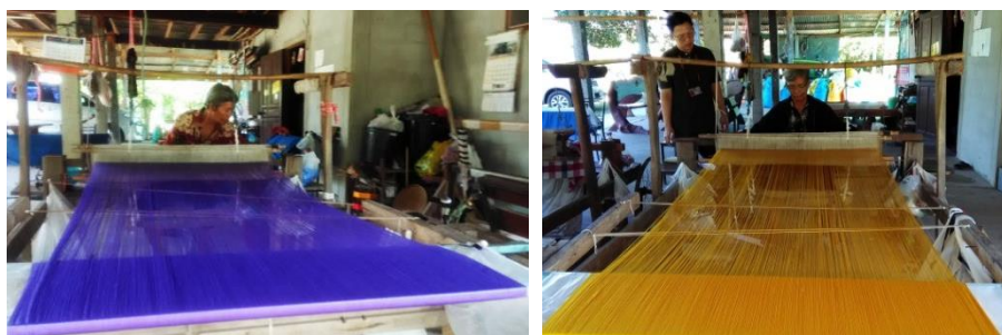
ภาพที่ 4 ไหมเส้นพุ่งที่มีการแยกออกเป็นชุด ๆ เพื่อมัดหมี่และย้อมสีตามตำแหน่งของลาย
