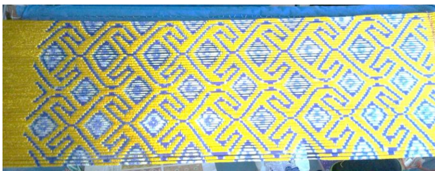
ภาพที่ 4 ไหมเส้นพุ่งที่มีการแยกออกเป็นชุด ๆ เพื่อมัดหมี่และย้อมสีตามตำแหน่งของลาย
