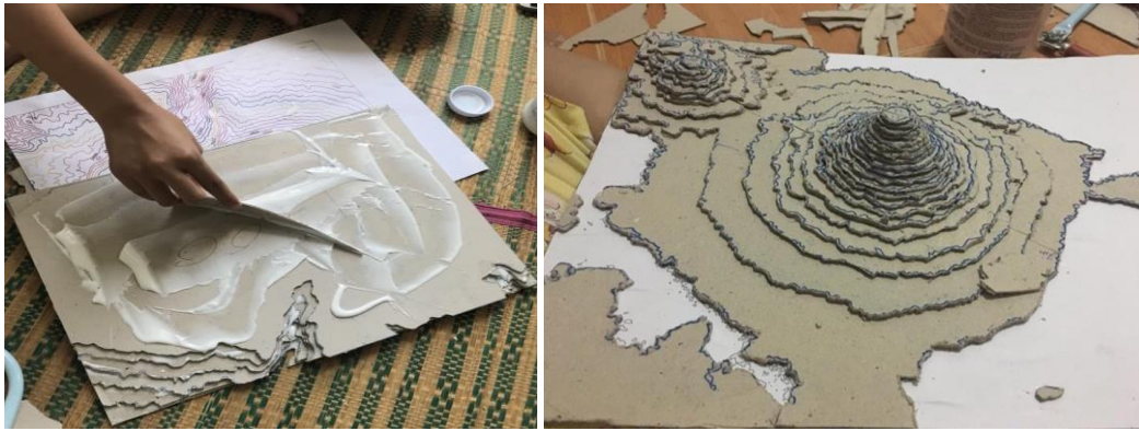
ภาพประกอบ 8.15 การติดกระดาษหลังรูปที่ละชั้นจากเส้นชั้นความสูงต่ำสุด
