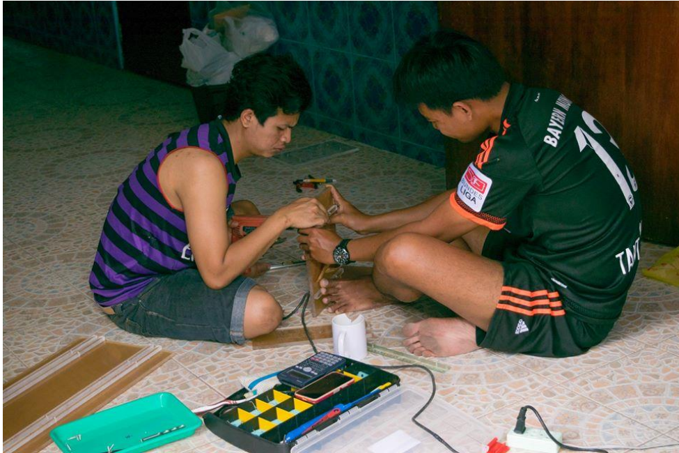
รูปที่ ก-7 การประกอบโครงสร้างเครื่องส่งพลังงานไฟฟ้าแบบไร้สายด้วยอะคริลิกขนาด 10 mm ลักษณะที่ 3
