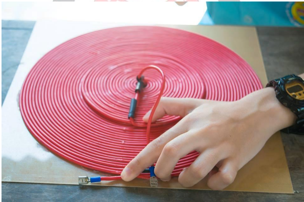
รูปที่ ก-12 การพันขดลวดด้วยสายไฟทองแดงของเครื่องส่งพลังงานไฟฟ้าแบบไร้สาย, ลักษณะที่ 1
