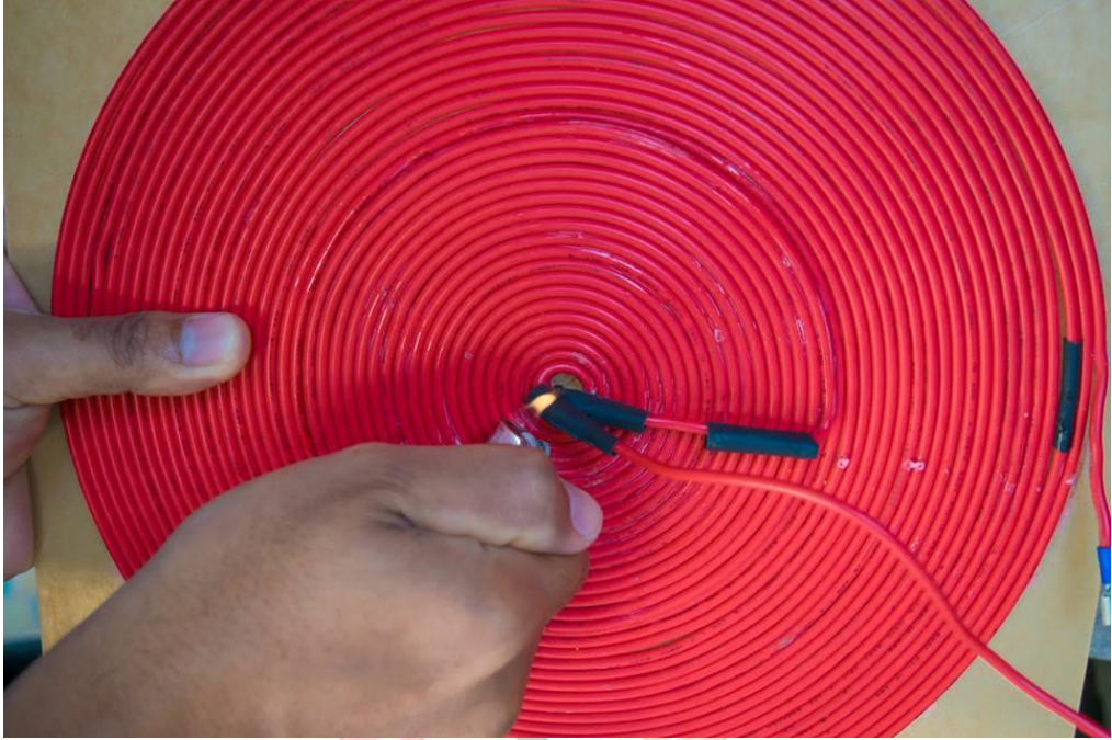
รูปที่ ก-13 การพันขดลวดด้วยสายไฟทองแดงของเครื่องส่งพลังงานไฟฟ้าแบบไร้สาย, ลักษณะที่ 2
