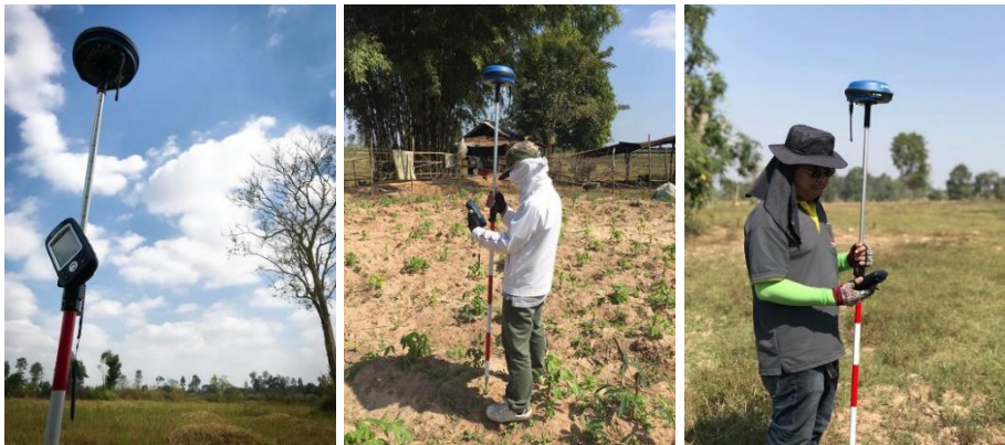
ภาพประกอบ 1.2 การสำรวจชั้นสูงด้วย GPS เครื่องรับแบบรังวัด
