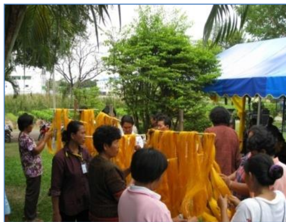
ภาพที่ 4.15 การนำเส้นใยไปผึ่งแดดให้แห้งสนิท
