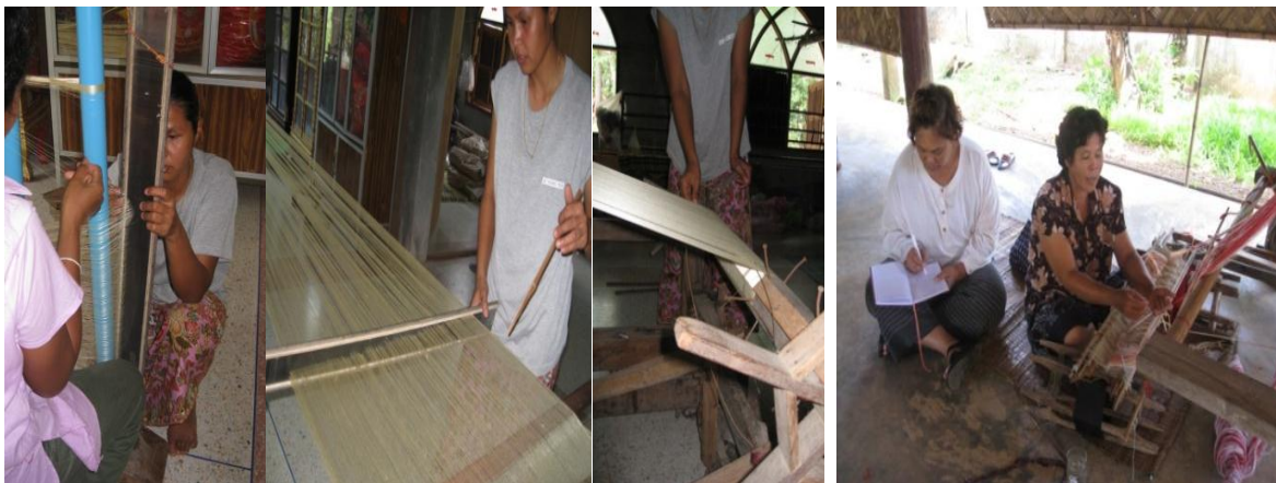
ภาพที่ 4.20 ร้อยฟันหวี หวีเส้นยืน และม้วนหัวม้วนเส้นยืน
