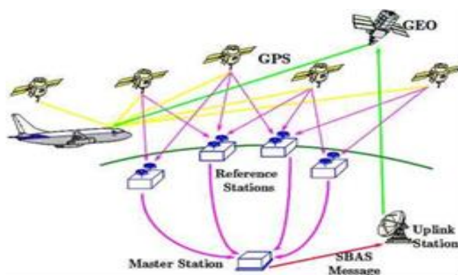
ภาพที่ 2.7 การทำงานของเอสบาสที่ใช้ระบบนำร่องจีเอ็นเอสเอส – 1 สำหรับการบินพาณิชย์
