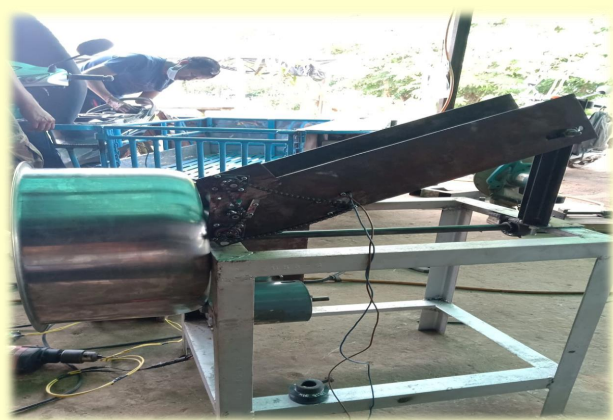
รูปที่ 2 แสดงโครงร่างของเครื่องหั่นตะไคร้กึ่งอัตโนมัติ
