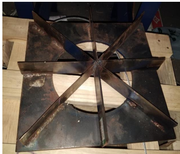
ภาพที่ 3.9 ใบมีดด้านชุดผ่าที่สร้างขึ้น
