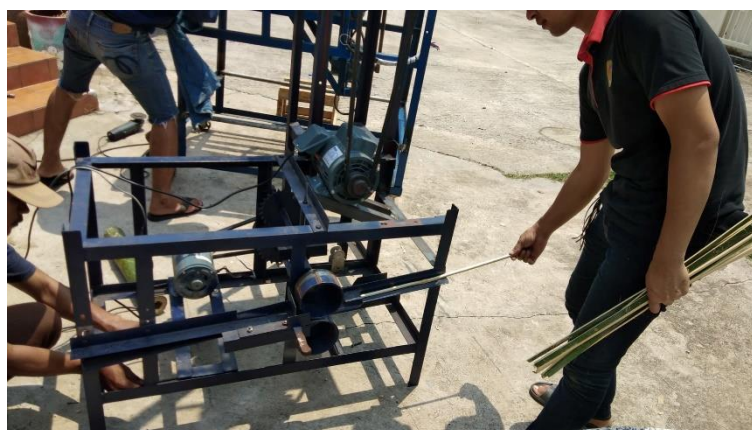
ภาพที่ 3.20 การจักตอกไม้ไผ่ด้วยเครื่องผ่าและจักตอกไม้ไผ่
