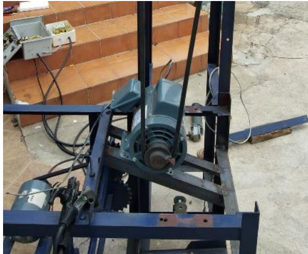
ภาพที่ 3.18 การวัดค่าความเร็วรอบ การวัดค่าแรงดันและค่ากระแสไฟฟ้ามอเตอร์ AC ของมอเตอร์ ชุดฝาไม้ไผ่
