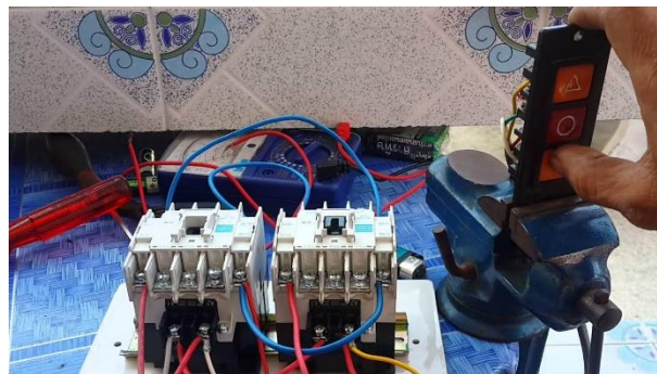
ภาพที่ 3.13 วงจรสลับทางมอเตอร์ AC ด้วยแมกเนติก 2 ตัว ที่สร้างขึ้น
