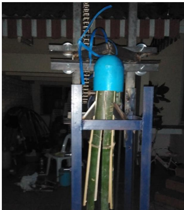
ภาพที่ 3.19 การผ่าไม้ไผ่ด้วยเครื่องผ่าและจักตอกไม้ไผ่
