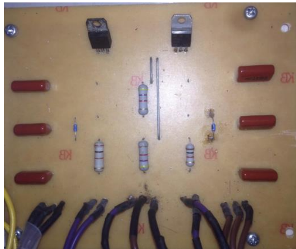
ภาพที่ 3.11 วงจรปรับความเร็วมอเตอร์กระแสสลับ ที่สร้างขึ้น
