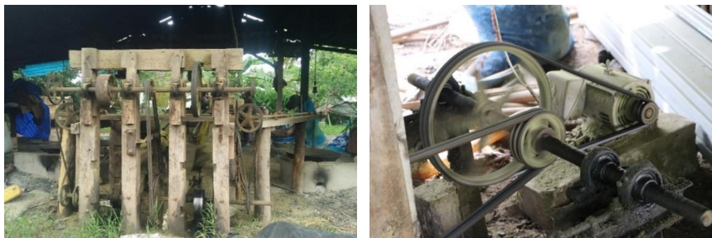
ภาพที่ 2.8 ชุดต้นกำลังในการขับเคลื่อนกระต๋องตำข้าวเม่า
