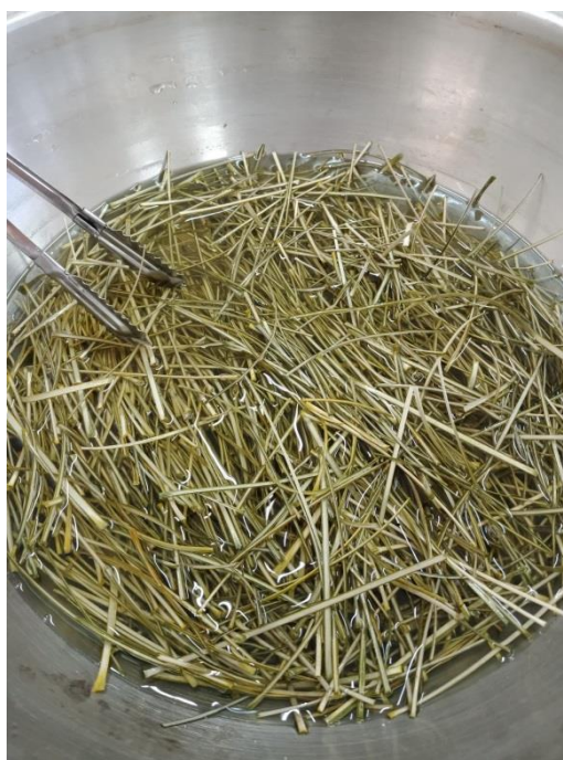
แช่เส้นใยใบเตยหนามในสารละลายโซเดียมคาร์บอเนตและโซเดียมไฮดรอกไซด์ เป็นเวลา 1 ชั่วโมง
