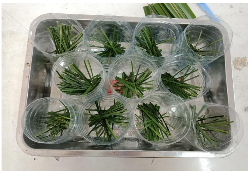
ซอยใบเตยหนามเป็นเส้นใยโดยมีขนาดความกว้างเท่ากับ 3 มิลลิเมตร
