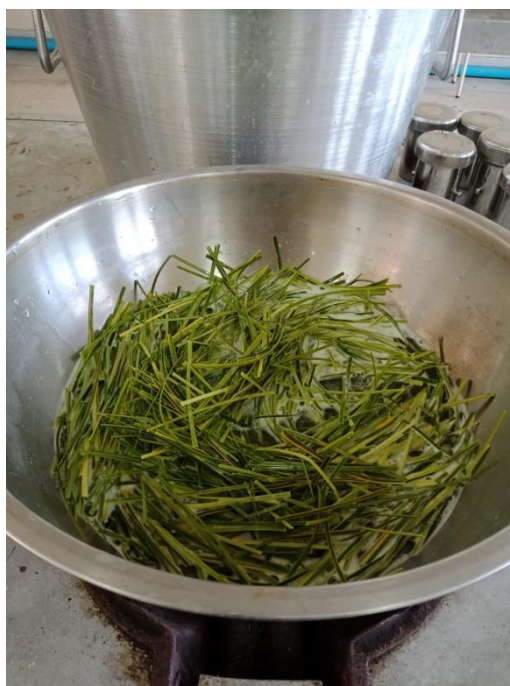
ต้มเส้นใยใบเตยหนามด้วยสารละลายไฮโดรเจนเปอร์ออกไซด์ เพื่อฟอกขาว เป็นเวลา 2 ชั่วโมง
