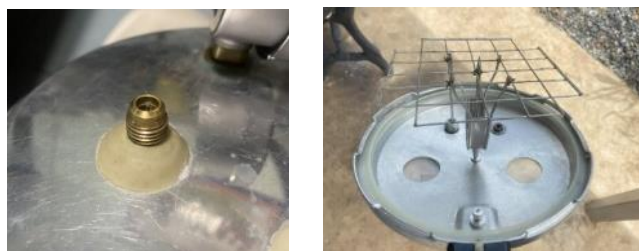
ก. ติดตั้งวาล์วสุญญากาศ ข. ชุดกักخينงาน ภาพที่ 5 ติดตั้งวาล์วสุญญากาศ และชุดกักخينงาน
