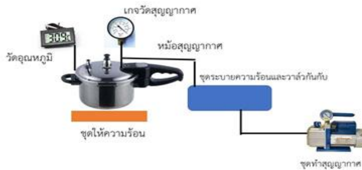
ภาพที่ 6 โดอะแกรมการทำงานของหม้อสุญญากาศ
