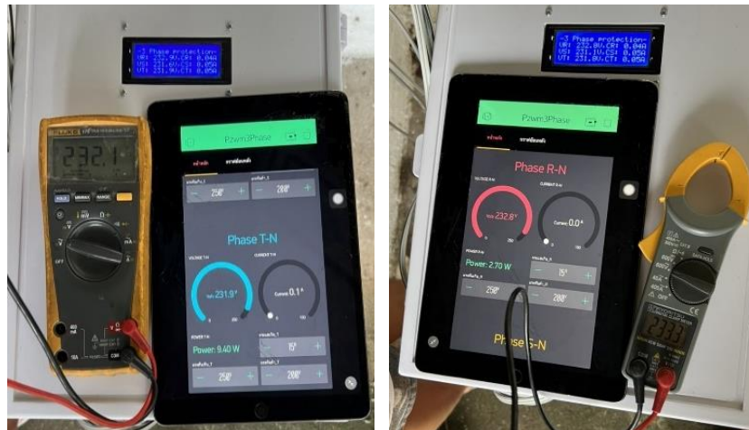
ภาพที่ 11 การแสดงผลที่จอ LCD และแอปพลิเคชัน Blynk เทียบกับเครื่องวัดมาตรฐาน
