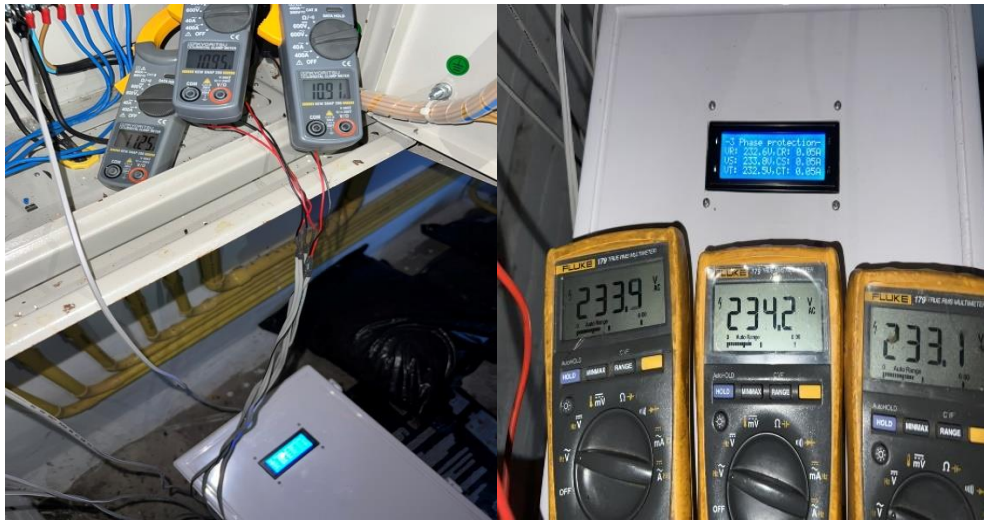
ภาพที่ 10 แสดงผลการวัดแรงดันไฟฟ้าและกระแสไฟฟ้าเทียบกับเครื่องวัดมาตรฐานทั้ง 3 เฟส
