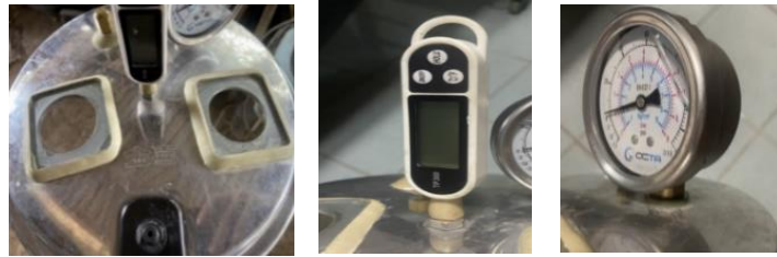
ภาพที่ 4 ติดตั้งเกจวัดความดัน วัดอุณหภูมิและกระจกใสบนฝาหม้อแบบสุญญากาศ
