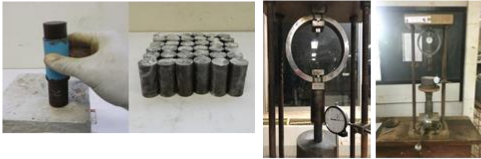
รูปที่ 1 การเตรียมตัวอย่างจีโอโพลีเมอร์ การทดสอบกำลังอัดและการทดสอบระยะเวลาการก่อตัว
