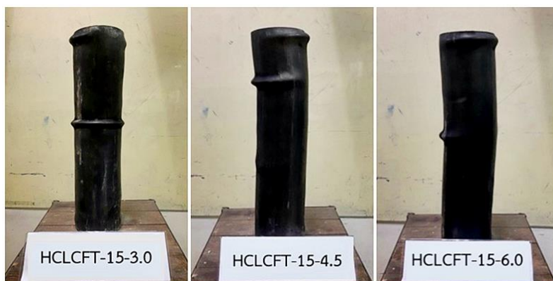
รูปที่ 4 ลักษณะการวิบัติของตัวอย่างเสาท่อเหล็กกรอกคอนกรีตมวลเบาแบบเซลล์สุ่มที่ใช้ไฮบริดซีเมนต์
