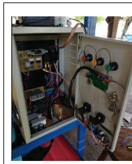
ภาพที่ 4 ภายในตู้ควบคุมที่ใช้บอร์ดไมโครคอนโทรลเลอร์ Arduino Uno R3 เป็นตัวควบคุม
