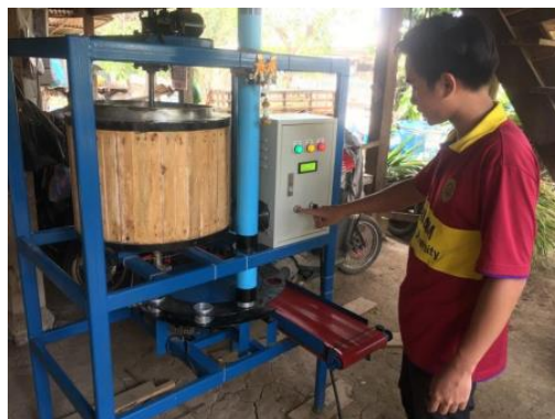
ภาพที่ 5 เครื่องทำน้ำตาลอ้อยแบบกึ่งอัตโนมัติที่ควบคุมด้วยไมโครคอนโทรลเลอร์ Arduino Uno R3
