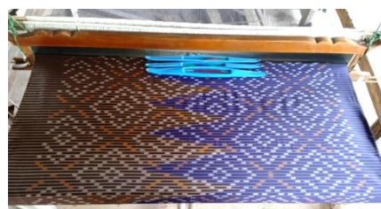
ผืนที่ ๒๘ ขณะทอแทรกด้วยด้ายเส้นพุ่งสีน้ำตาลและสีม่วง สังเกตขอบเขตของสีเป็นเส้นฟันปลาที่ชัดเจน
