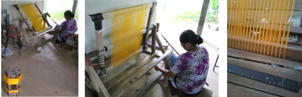
ภาพที่ ๑.๙ การคั่นไหมด้วยเครื่องโยกไหม ที่มา: สมบัติ ประจัญสานต์, ๒๕๖๓ก: ๑๐
