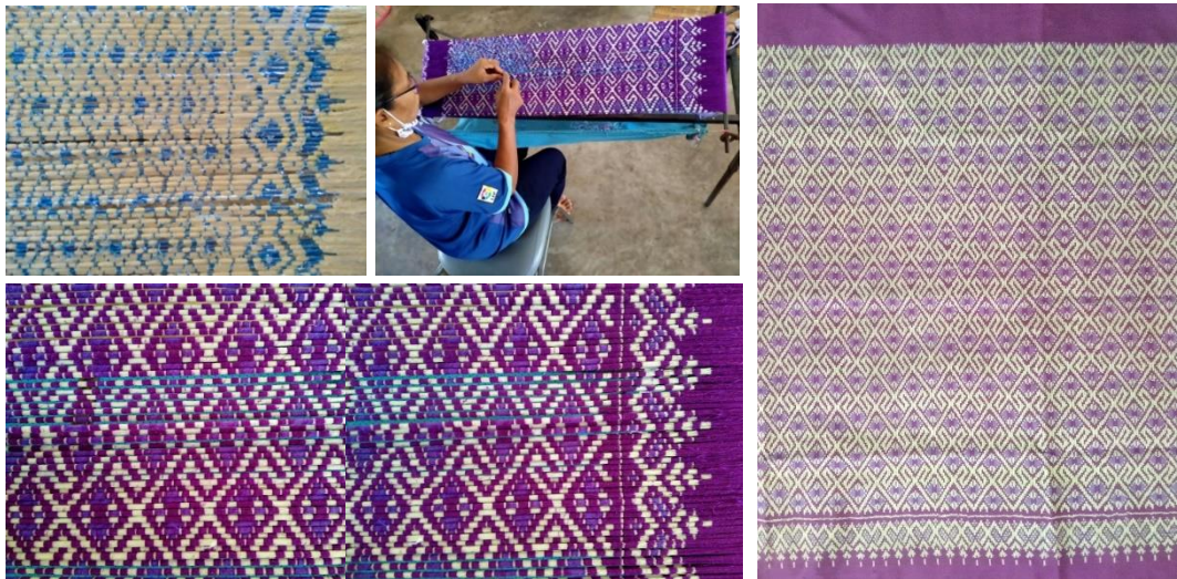
ภาพที่ ๑.๒ การมัดหมี่ที่เส้นด้ายพุ่งเป็นลวดลายเพื่อนำไปทอเป็นผืนผ้า ที่มา : สมบัติ ประจักษ์สานต์, ๒๕๖๔ : ๖
