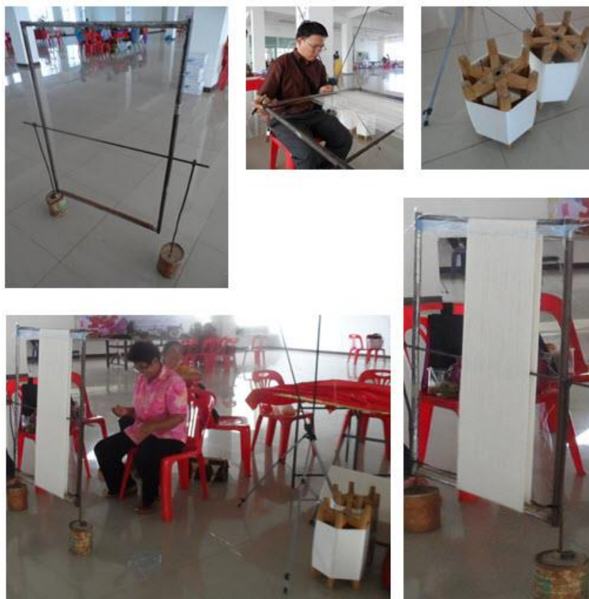
ภาพที่ 4.19 การเตรียมเส้นไหมฟุ้งด้วยเครื่องโยกหมี่อย่างง่าย
