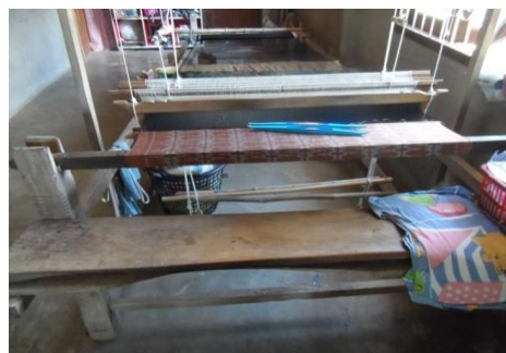
ภาพที่ 4.13 ขนาดความกว้างของเครื่องโยกหมี่ที่ไม่สัมพันธ์กับความกว้างของฟืม
