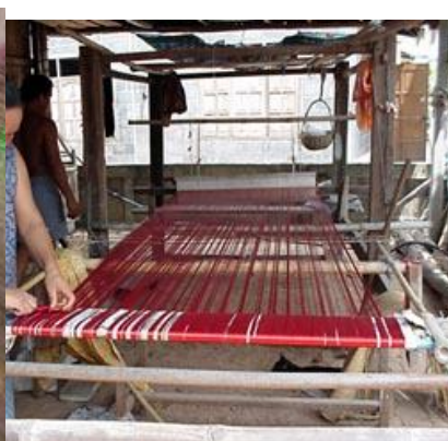
ภาพที่ 60 นำเส้นไหมที่ต่อกับฟืมมาขยายใส่ไม้พับหัว
