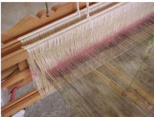
ภาพที่ 59 นำเส้นไหมมาสืบหูกคือการต่อเส้นไหมเข้ากับฟืม
