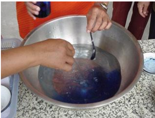
ภาพที่ 130 ตวงน้ำสำหรับย้อม จากนั้นผสมสีที่ละลายแล้ว คนให้เข้ากัน
