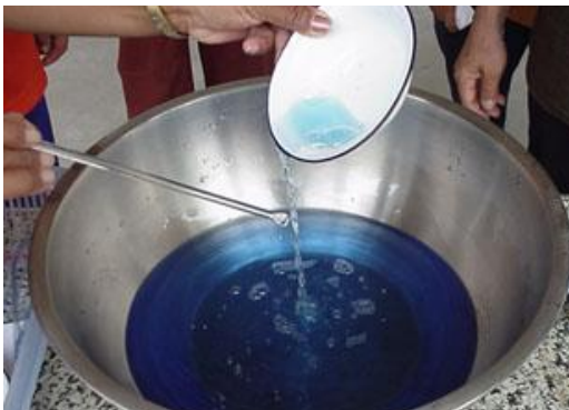
ภาพที่ 132 ผสมน้ำยาล้างจานหรือสบู่เหลวลงในน้ำย้อม นำเส้นไหมลงย้อมใช้เวลาประมาณ 3-5 นาที
