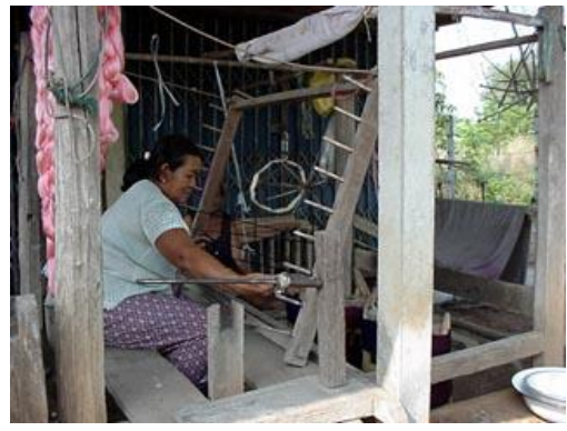
ภาพที่ 58 นำเส้นไหมมาคืนเครื่องแล้วนำไปขยายให้ตรงและดึงเส้นไหมให้ตึงเท่าๆกัน
