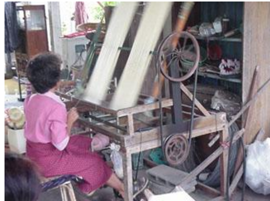
ภาพที่ 46 การทำงานของเครื่องอั่งคั้นไหมอาศัย การหมุนของเฟืองทด
