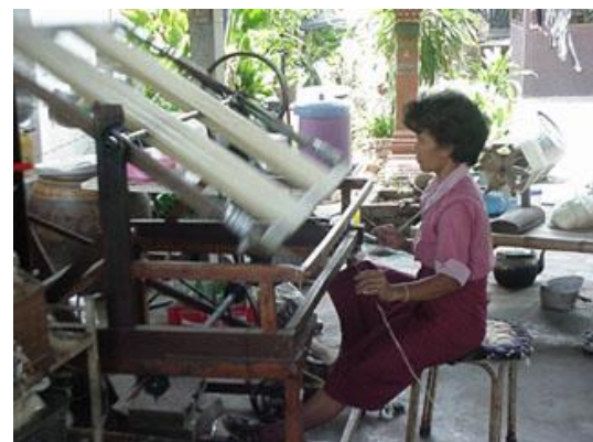
ภาพที่ 48 ผู้ที่ชำนาญสามารถคั้นไหมจาก 2 อักพร้อมกันได้
