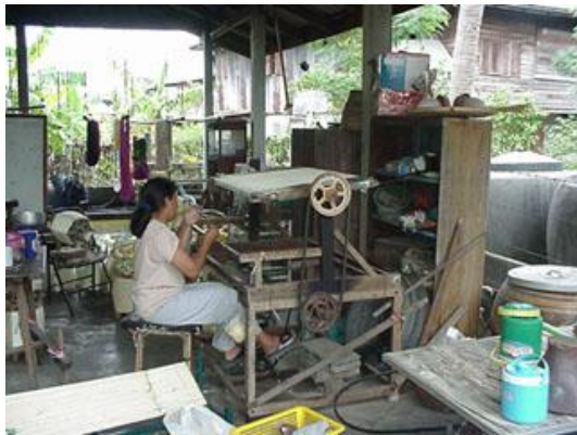
ภาพที่ 45 เครื่องอั่งคั้นไหมเป็นเครื่องทุนแรง ที่ประดิษฐ์ขึ้นโดยชาวบ้าน ราคา ต้นทุน 4,000 บาทต่อเครื่อง
