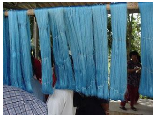
ภาพที่ 139 ไหมที่ได้จากการต้มสีแอสิคสีฟ้า
