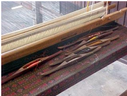
ภาพที่ 70 นำหลอดไหมมาใส่ในกระสวย เพื่อใช้ทอเป็นเส้นพุ่ง ทอขวาง กับเส้นไหมที่เป็นเส้นยืน
