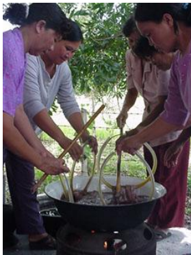
ภาพที่ 136 นำไหมลงต้มอีกครั้งหมั่นยก ขึ้นลงจนน้ำขุ่นใสและตามเวลาที่กำหนด
