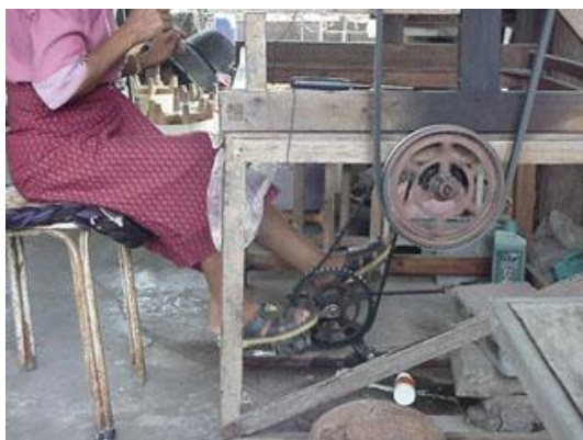
ภาพที่ 47 ผู้ใช้ต้องออกแรงในการปั่นจักร เพื่อหมุนเฟืองให้ทำงาน
