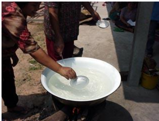
ภาพที่ 105 การผสมสารลอกกาวกับน้ำที่ผ่านการชั่งตวงตามสัดส่วน
