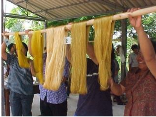
ภาพที่ 55-56 นำไหมขึ้นกระตุกให้เรียบ และผึ่งลมให้แห้ง อย่างนำไหมตากแดด
