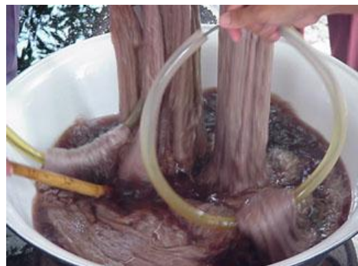
ภาพที่ 133 นำเส้นไหมขึ้นจากอ่างย้อมแล้วนำน้ำย้อมขึ้นตั้งไฟ วัตถุประสงค์ของน้ำตามที่กำหนดด้วยปรอทแล้วนำเส้นไหมย้อมลงในน้ำย้อมตามเวลาที่กำหนดแล้วยกขึ้นพักไว้
